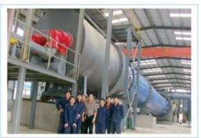
泰达MGT系列新型节能转筒式干燥机是在传统转筒烘干机的基础上经过多次改进的一种新型干 燥机。由于运转可靠、操作弹性大、适应性强、处理量大,广泛应用于冶金、建材、食品、轻工、化工、煤炭、医药、矿产行业中。 MGT干燥机一般适用于颗粒、粉末状物料,流动性较好的物料。如:砂石、矿渣、矿粉等。它的优点是生产能力大、适用范围广、风阻小、操作简便方便等。
